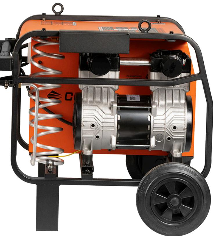
→ Отсутствие ресивера исключает образование конденсата, что продлевает срок службы расходных частей плазмотрона и улучшает качество реза, сохраняет чистоту внутренней газовой магистрали аппарата и шлейфа плазмотрона.
